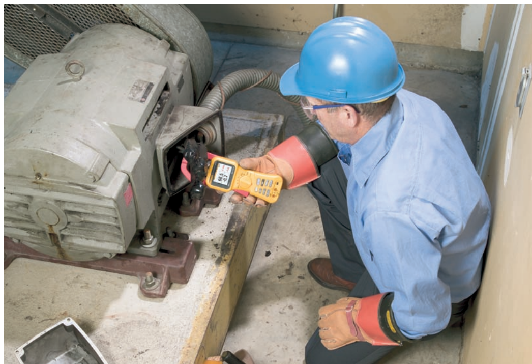
Figura 1. Il doppio display del Fluke 345 consente di visualizzare sia le forme d'onda in corrente che quelle in tensione.
