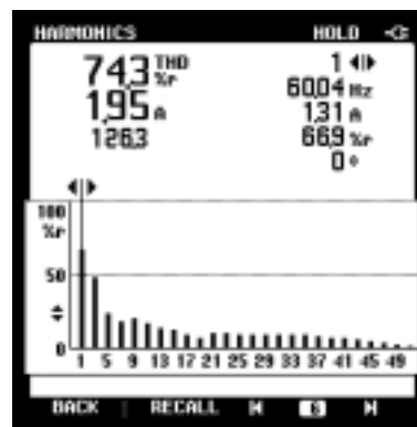
Fig. 3 Espectro armónico de la corriente de una lámpara fluorescente compacta
