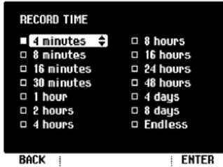
Ejemplo de una grabación de un analizador de la calidad de la energía con tiempo de grabado de 4 minutos - sin término (16 días)
