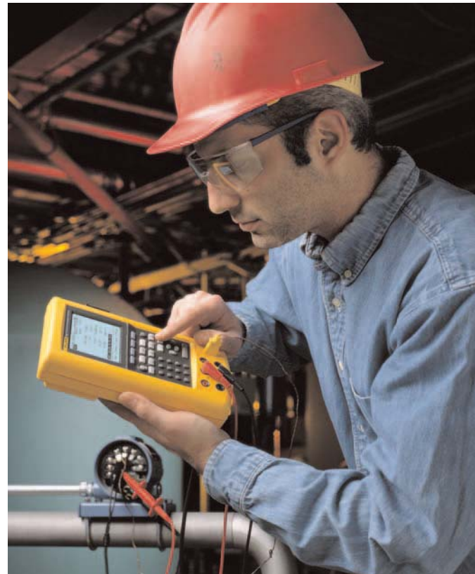
El calibrador Documentador de Procesos Fluke 744 HART, permite a los técnicos calibrar, mantener y documentar dispositivos HART sin la necesidad de equipo adicional.
