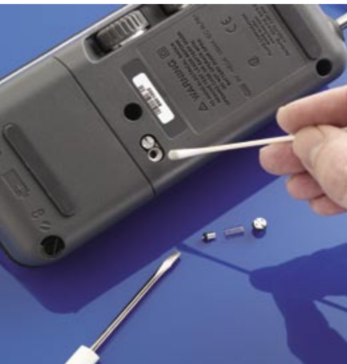
La limpieza de líquidos acumulados en el calibrador Fluke-718 es rápida, fácil y sólo requiere un destornillador ranurado y un bastoncillo de algodón.
