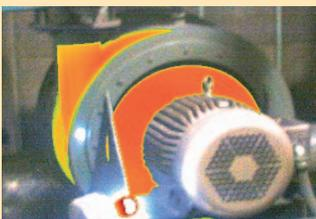
**Alarma de color/IR (IR/color alarm):** aísla las áreas problemáticas mostrando una imagen visual en la que se incluyen zonas infrarrojas que indican temperaturas que el usuario ha seleccionado destacar dentro de un determinado intervalo.
