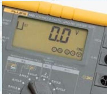
Utilisez le Fluke 1625 pour déterminer l'intégrité de vos réseaux de mise à la terre.
