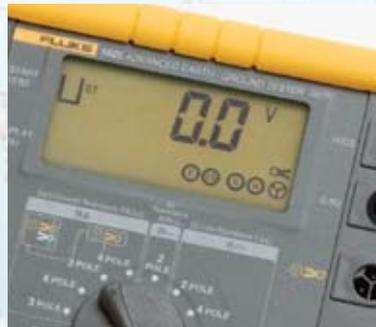
Utilice el Fluke 1625 para determinar el estado de sus sistemas de conexión a tierra física.
