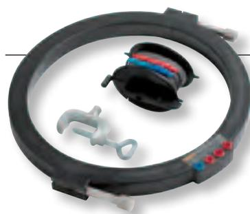
Confira a resistência de aterramento de torres elétricas sem desconectar a conexão de aterramento da utilidade. Em conjunto com o Fluke 1625 ou o Fluke 1623, este alicate seletivo para medição de resistência de circuito de aterramento é usado ao redor de torres de transmissão/energia elétrica. Diâmetro interno do alicate é de 320 mm (12,6 pol.). Inclui transformador de núcleo dividido, manual do usuário e todas as conexões e adaptadores necessários para o Fluke 1623 e 1625.
