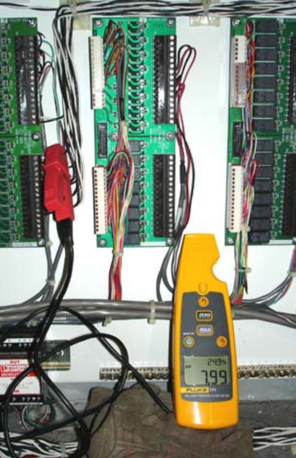
Figura 2: En aplicaciones específicas, las lecturas de porcentaje en el Fluke 771 pueden resultar más útiles que las lecturas de corriente subyacentes: por ejemplo, cuando debe mantenerse una salida de control dentro del intervalo de 25-30 % del nivel máximo. Aquí, el Fluke 771 está conectado al bucle de control de emisiones.
