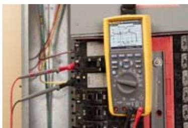
**Fluke 289** Multímetro industrial True-RMS
