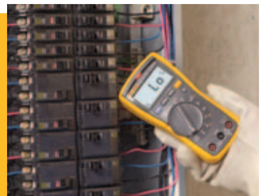
Este medidor tiene un comprobador de tensión sin contactos incorporado.
