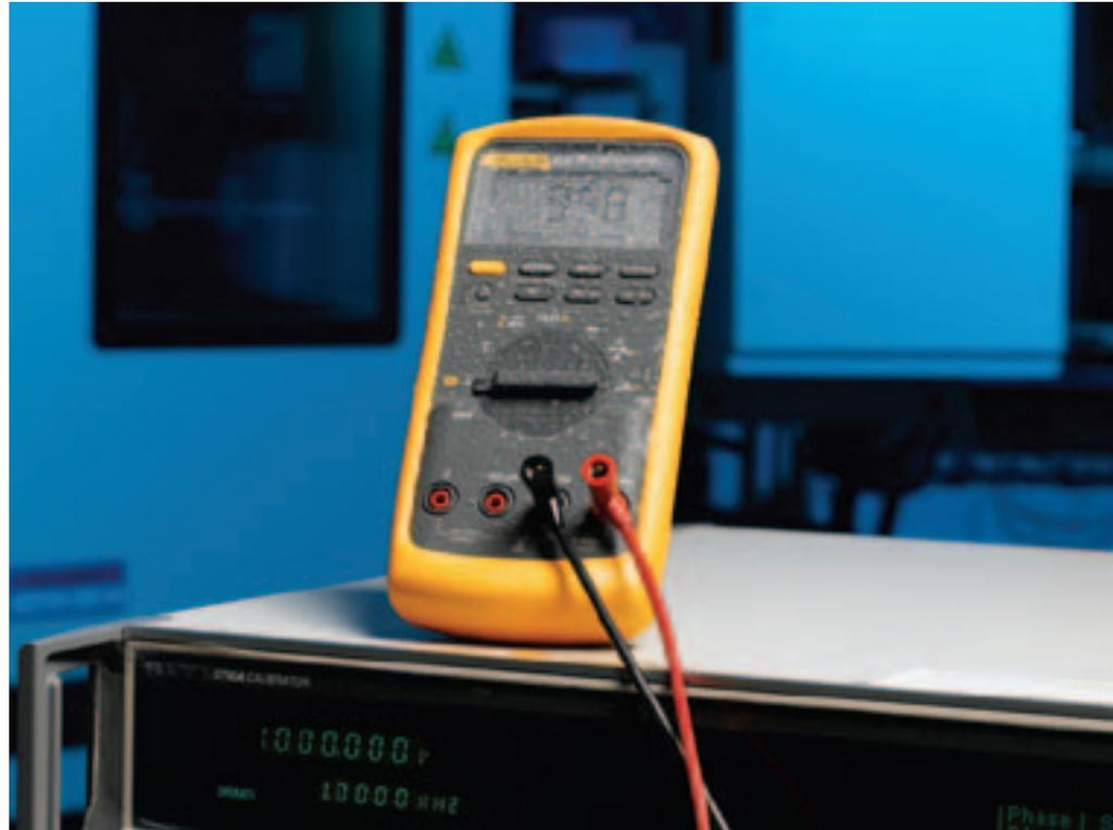
Un medidor, recién sacado de la cámara de pruebas a  $-20\text{ }^{\circ}\text{C}$  ( $-4\text{ }^{\circ}\text{F}$ ), midiendo  $1000\text{ V CA}$   $1\text{ KHz}$  mientras está cubierto de hielo.
