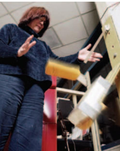
Prueba de caída. Un medidor con especificación de -10 a 50 °C, como el Fluke 179, se deja caer desde 1 metro sobre sus seis laterales a -10 °C y, a continuación, a 50 °C.
