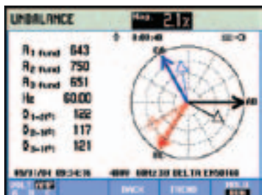
Fig. 4 Corrente em ampères da fase desequilibrada
