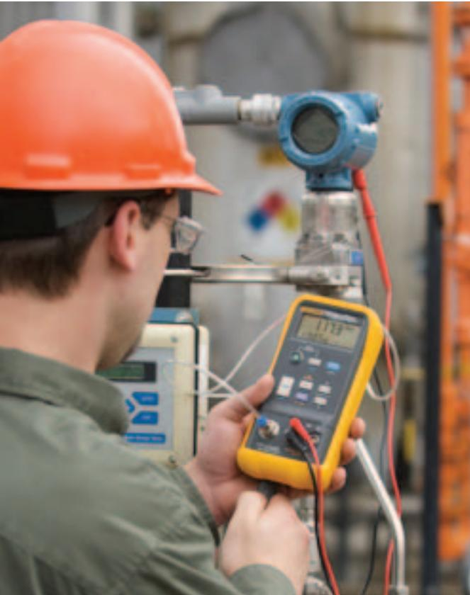
Fluke 719 Calibrador de presión eléctrico
