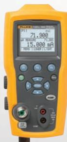
Calibrador eléctrico de presión
