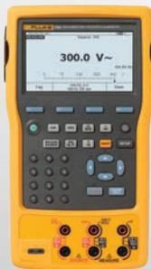
Calibrador de procesos documentador Fluke 754 con soporte HART
