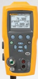
Los calibradores eléctricos de presión Fluke 719Pro con bomba eléctrica incluida facilitan la calibración de la presión, con solo pulsar un botón. El 719Pro incluye, además, un calibrador de circuitos de funcionamiento completo que alimenta, simula y mide las señales de mA. La precisión líder en la industria del 719Pro lo convierte en una herramienta ideal y altamente confiable para comprobar los transmisores de presión de alta precisión.
