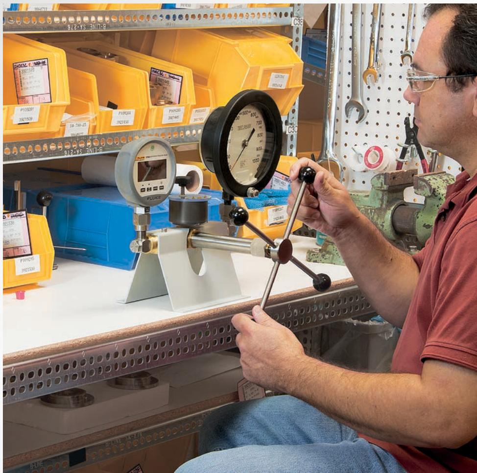
Un comparador de presión es un instrumento conveniente para la calibración de presión en el banco. Las calibraciones de banco se realizan para mantener las condiciones de referencia y para obtener las incertidumbres en el nivel más bajo posible. El banco también es un lugar conveniente para inspeccionar, ajustar y reparar los dispositivos bajo prueba.
