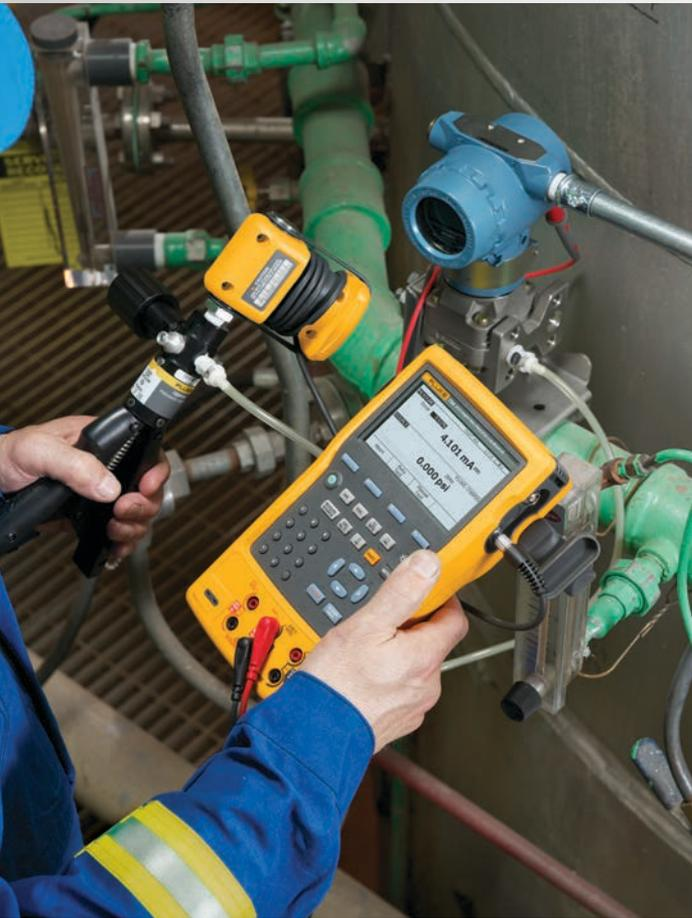
Los fabricantes de transmisores de presión mejoraron la precisión y la tecnología que se diseñó para estos dispositivos de medición de presión inteligentes. Muchas herramientas de calibración convencionales se han vuelto inapropiadas o simplemente incapaces de comprobar y calibrar los transmisores de presión de alta precisión. Se requieren mejores soluciones para las pruebas.
