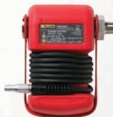
Los **módulos de presión Fluke serie 700PEX** le permiten medir la presión con los calibradores Fluke intrínsecamente seguros, como 718Ex y 725Ex. Los módulos de presión miden la presión utilizando un microprocesador interno. Reciben su alimentación eléctrica de los calibradores intrínsecamente seguros y le envían a estos la información digital.
