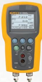
Los calibradores de presión de precisión Fluke 721 con sensores de presión dobles y aislados son las herramientas ideales para las aplicaciones de transferencia de gas para custodia. Con una sola herramienta, tome simultáneamente las mediciones de presión estática y diferencial, y mida los mA y la temperatura.
