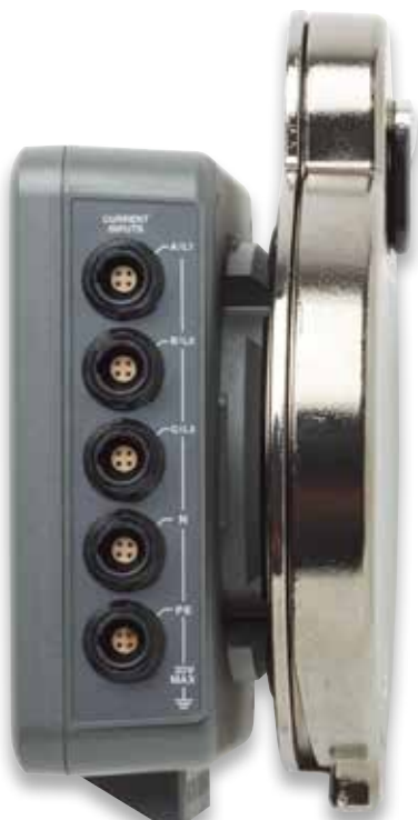
Entradas de corriente para instalar sondas de medición en el interior del panel eléctrico
