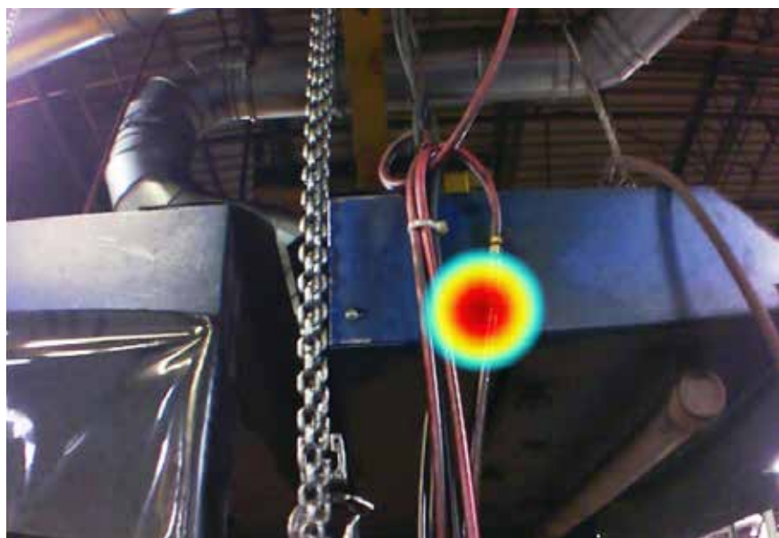
Images prises avec la caméra acoustique ultrasonore Fluke ii900 dans un environnement industriel.
