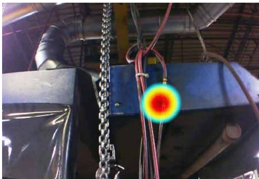
Beelden gemaakt met de ii900 Sonic Industrial Imager in een industriële omgeving.
