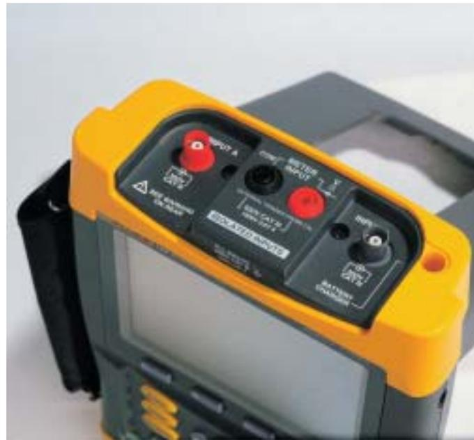
conexión a tierra para convertir sus entradas en flotantes, lo que aumenta el peligro de que se produzcan daños personales o incluso de electrocutarse. El nivel de aislamiento de los canales del ScopeMeter 190 protege la unidad, el equipo que está comprobando, su inversión en instrumentos de medida y, por supuesto, su integridad física.
