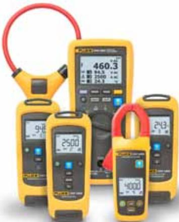
„Gerade in verschmutzten Umgebungen bietet das System immense Vorteile. Die Anlage muss nicht bei geöffnetem Schaltschrank betrieben werden, sondern das Modul kann an der Schalttafel hängen, der Schrank kann geschlossen und die Anlage kann in sicherer Entfernung gefahren werden, während sie die Anlaufphase oder andere Prozesse durchläuft. So sammelt sich kein Schmutz im Steuerungs- oder Verteilerkasten.“
