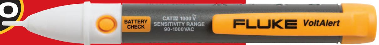
O 2AC é o produto da família de testadores de tensão sem contato para CA com tecnologia VoltAlert™ da Fluke. O 2AC cabe no bolso e é fácil de usar. Basta tocar a ponta em uma fita, saída ou cabo. Quando a ponta ficar vermelha, significa que há tensão na linha. Eletricistas,
