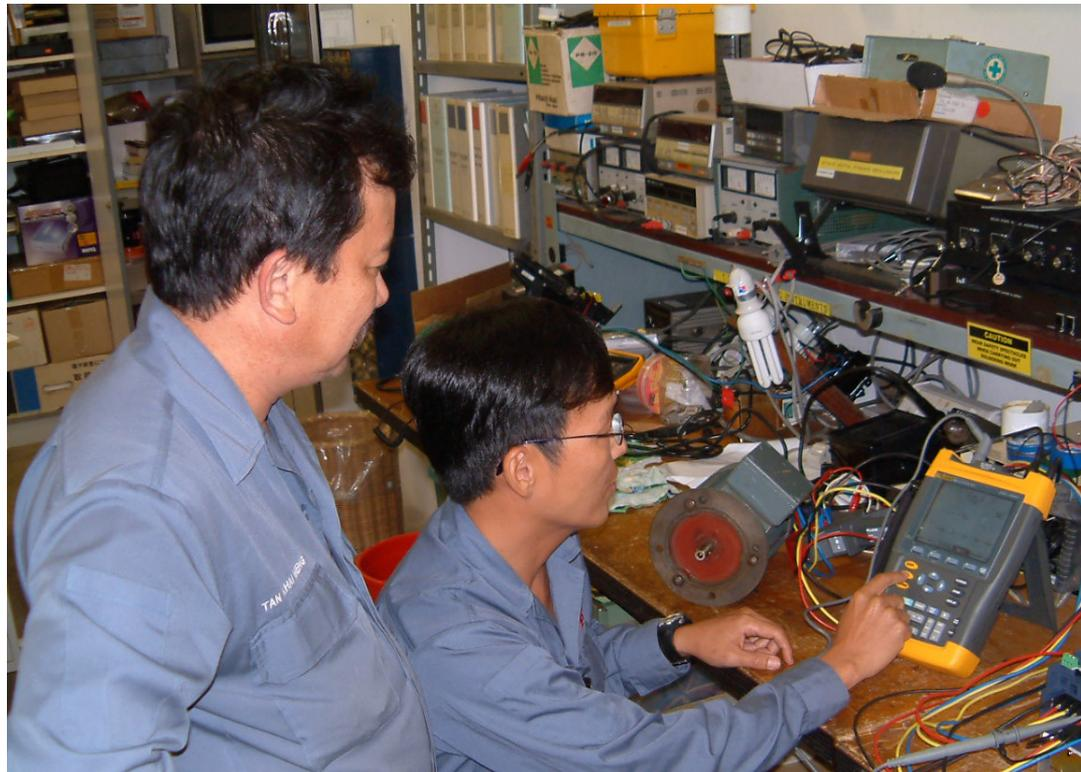
Mr. Tan dan Mr. Awyong melakukan pengukuran gerak kecepatan menggunakan alat uji ScopeMeter Fluke 192.
