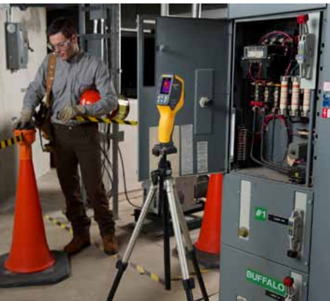
U přístroje VT04 je k dispozici automatické sledování s alarmem.
