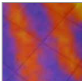
Kontrola wodnego ogrzewania podłogowego
