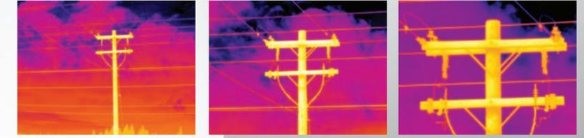
Standar (kiri), telefoto 2x (tengah) dan telefoto 4x (kanan)—melihat level detail inframerah penting secara tepat
