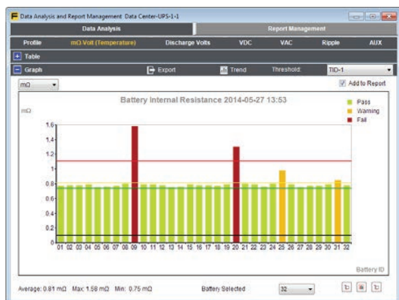
Histogramme d'une chaîne de batteries selon les seuils définis par l'utilisateur
