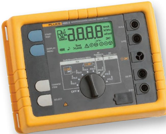
menggunakan penjepit. Dengan metode pengujian, dua penjepit di tempatkan di sekitar rod arde dan masing-masing penjepit tersebut dihubungkan ke tester. Stake arde tidak digunakan sama sekali. Tegangan tetap yang sudah diketahui diinduksi oleh salah satu penjepit dan arus diukur menggunakan penjepit kedua. Selanjutnya tester menentukan resistansi rod arde secara otomatis.
