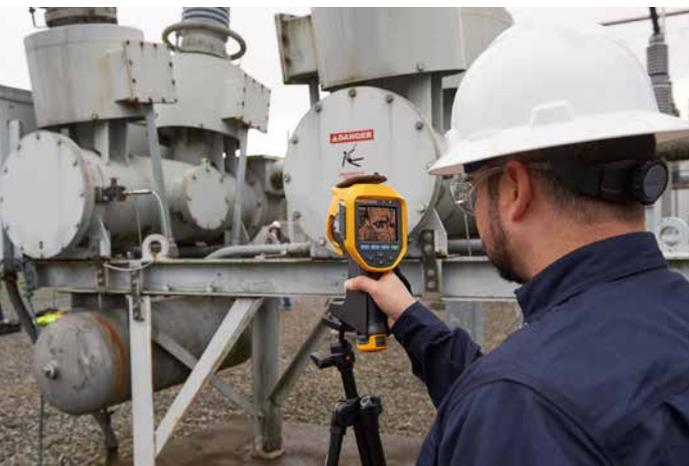
図 1. Ti450 SF6 ガス検知器によるボルト連結部の点検
