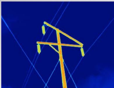
Poteau électrique haute tension, capturé avec une caméra TiX560 et un objectif standard.
