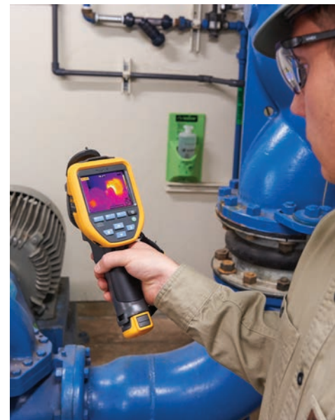
Inżynier korzystający z kamery termowizyjnej Fluke TiS75 do kontroli silnika
