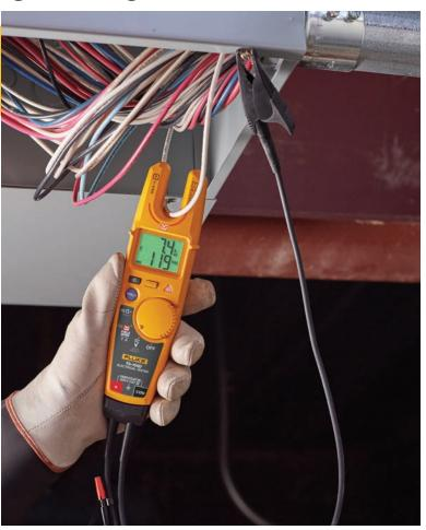
Dan oleh karena pengukuran dilakukan melalui insulasi kabel, Anda mengurangi paparan terhadap konduktor logam. Anda juga mengurangi potensi kesalahan, atau melakukan kontak dengan konduktor yang salah.
