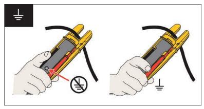
Teknologi FieldSenses berfungsi dengan menyediakan jalur kapasitif dari titik kontak di bagian belakang tester dan tangan operator ke earth ground.
