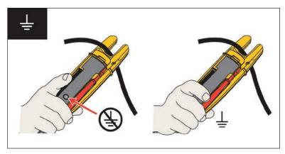
В основе технологии FieldSense лежит создание емкостной связи между точкой контакта, находящейся на задней панели тестера, рукой оператора и землей.
