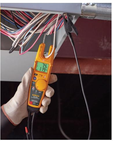
Так как измерения проводятся на кабелях с изоляцией, снижается риск касания металлических проводников. Кроме того, снижается риск ошибок при измерении или ошибочных контактов с проводниками.
