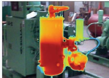
**Wärmebild-/Farbalarne:** Zeigt Problembereiche, die innerhalb eines vorwählbaren Temperaturbereiches liegen.
