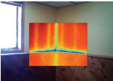
Mit der Bild-in-Bild-Funktion vermeiden Sie Ungewissheiten bei der Lokalisierung von Problemen. In dieser Betriebsart sehen Sie dank der IR-Fusion-Funktion, wo die Luft zwischen Wand und Fußboden entweicht.
