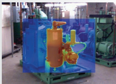
AutoBlend™: w trybie tym częściowo przezroczyste obrazy w podczerwieni są łączone z obrazami w zakresie światła widzialnego w jeden obraz ułatwiający wykrywanie problemów
