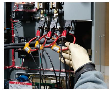
高調波 FFT のアルゴリズムは、狭義の意味では、クラ ス A 機器はすべて同じ高調波振幅に到達すべきであ る、というものです。FFT の手法では、さまざまなア ルゴリズの使用が許可されているため、一定の基準 を設けなければ、高調波振幅の結果に大きな違いが 生じる可能性があります。クラス A では、高調波は、 IEC 61000-4-7 (クラス I) / 2008 に従って、ギャッ プのない高調波サブグループ測定を使用して、同一サ イクル (10/20) の間隔 (実効値測定) で測定される必 要があります。IEC 6100-4-7 では、複数の高調波測 定の手法およびアルゴリズムが定義されていますが、 IEC 61000-4-30 では、特記としてクラス I (サブグルー プ化の手法)が定義されています。
