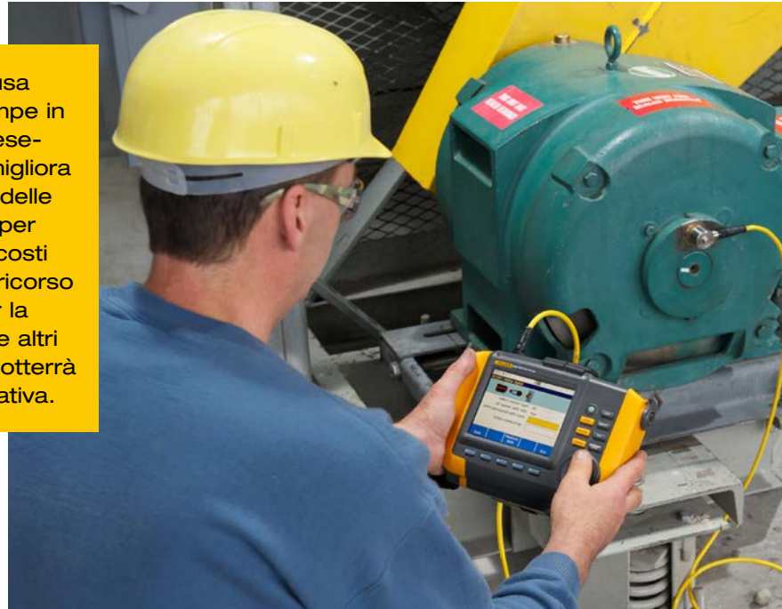
Il tester di vibrazioni 810 monitora i motori in funzione.
