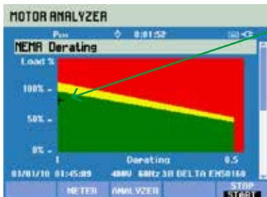
Le graphique de déclassement NEMA permet de déterminer rapidement si le moteur fonctionne en sur- ou en sous-régime.
