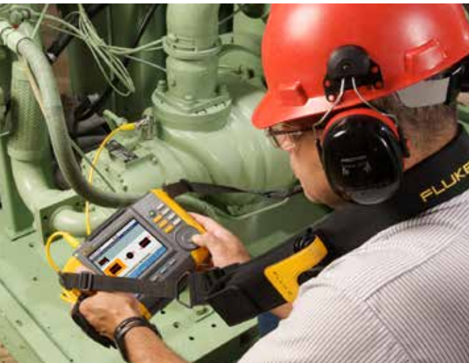
Das preisgekrönte Schwingungsmessgerät Fluke 810 verwendet ein automatisches Diagnoseprogramm, das Technikern hilft, effizient zu arbeiten.
