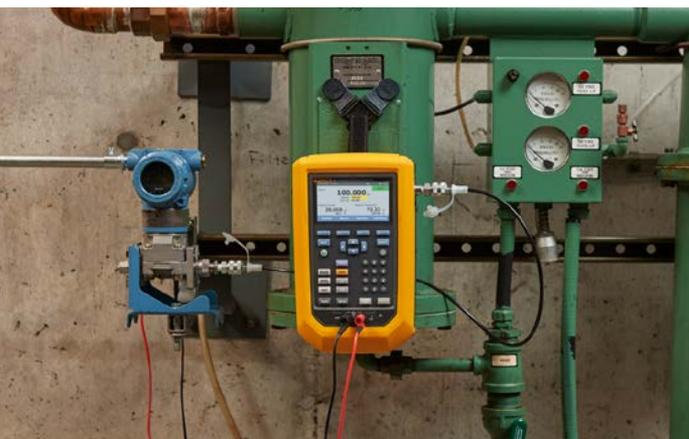
„Die automatische Pumpe am Druckkalibrator 729 reduziert Fehler durch handbetriebene Pumpen und verkürzt die Kalibrierzeit um etwa 40 %.“
