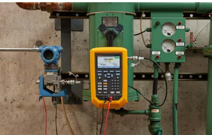
« La pompe automatique du calibrateur de pression 729 réduit les erreurs induites par un instrument à pompe manuelle, ainsi que les temps d'étalonnage d'environ 40 % »
