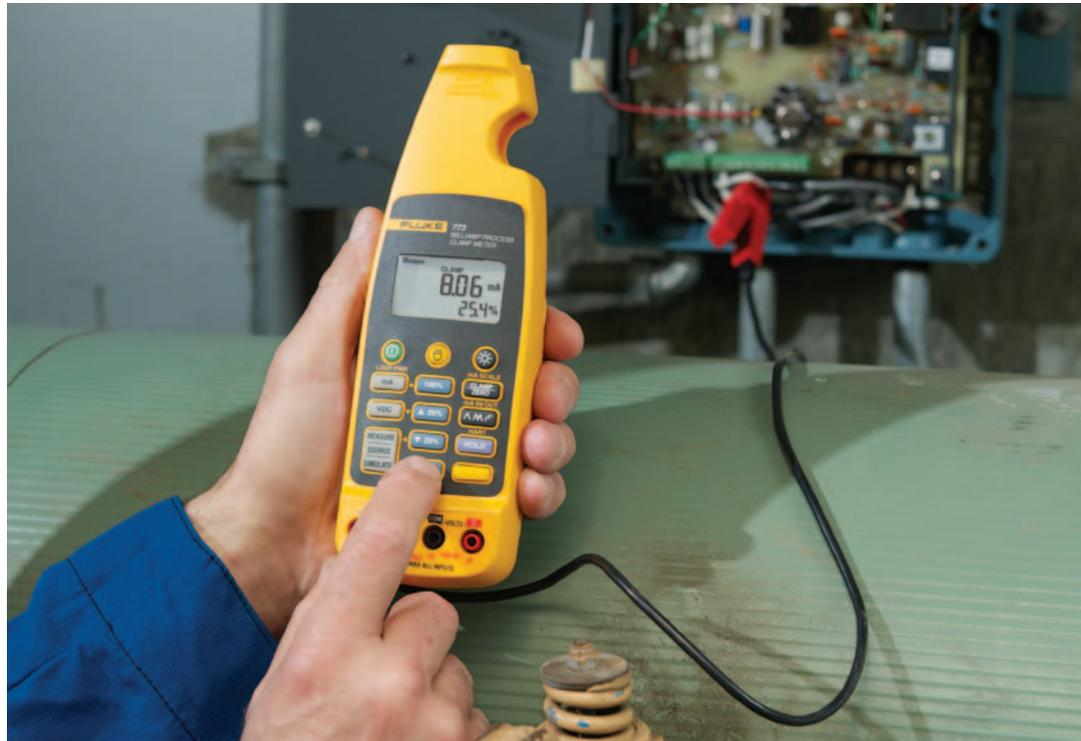
La sección de la Fluke 773 donde se encuentra la pinza es desmontable y se conecta al cuerpo principal de la herramienta de comprobación mediante un cable de extensión.
