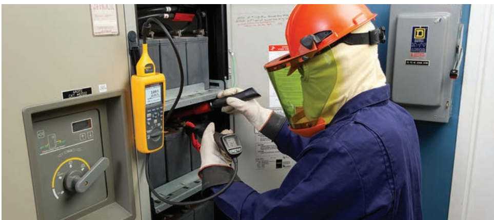
ใช้ Fluke BT52X เพื่อวัดอิมพีแดนซ์ สำหรับการทดสอบค่าโอห์มภายในของเซลล์/แบตเตอรี่ทุกไตรมาส
