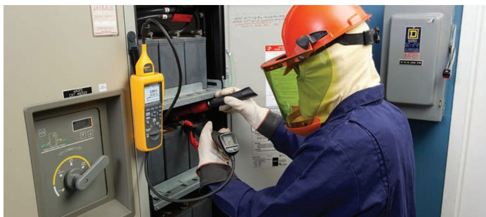
Použití Fluke BT52X k měření impedance pro čtvrtletní test interních ohmových hodnot článku/jednotky.
