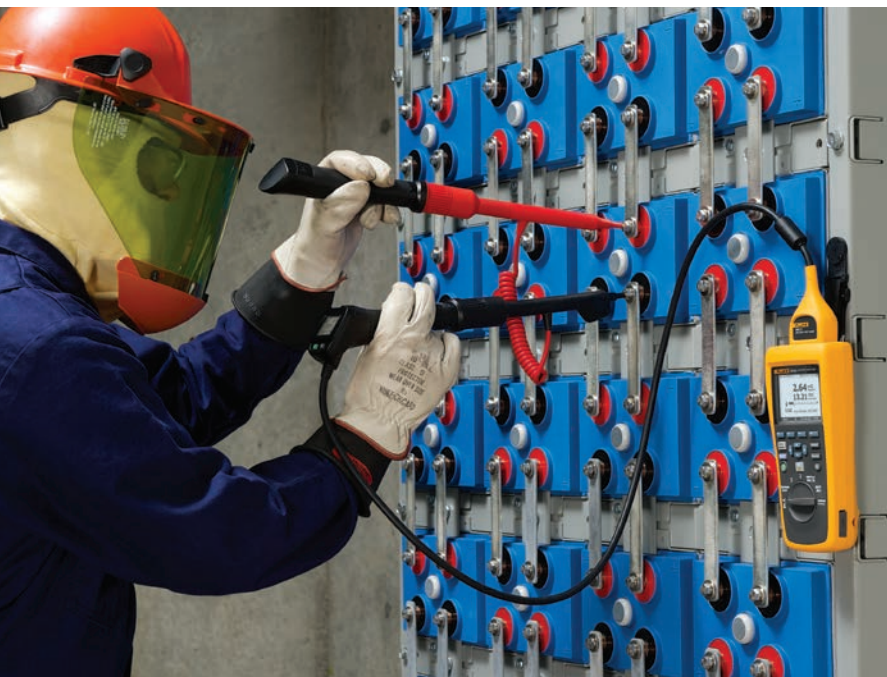
Måling af ohmske værdier i sekvenstilstanden
