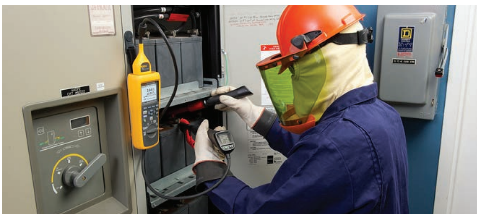
Använda Fluke BT52X för att mäta impedans, för kvartalsvisa test av cellens/enhetens inre resistansvärde.
