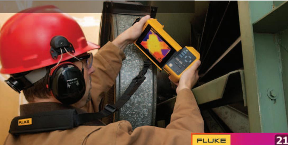
**Detecte rápidamente los rodamientos calientes con una cámara termográfica de alta resolución con lente articulada**
