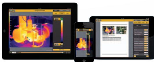
Con il software SmartView®, in dotazione alle termocamere ad infrarosso Fluke, è possibile eseguire ulteriori analisi e riscontri documentati nei rapporti comprendenti immagini a luce visibile e ad infrarossi e dati di misura. La maggior parte dei parametri possono essere modificati sull'immagine memorizzata, compresi emissività, gamma colori e livello/ampiezza.
