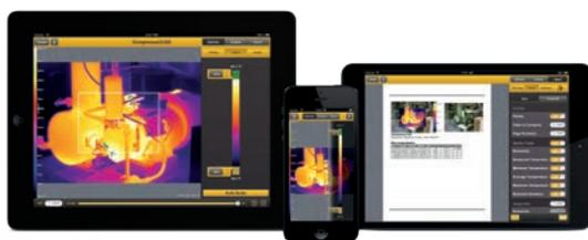
Com o software SmartView®, incluído nas câmaras termográficas Fluke, poderá executar análises adicionais e descobertas documentadas em relatórios que incluam imagens térmicas e de luz visível e dados de medição. Pode ajustar a maior parte dos parâmetros na imagem armazenada, incluindo emissividade, paleta de cores e nível/alcance, entre outros.
