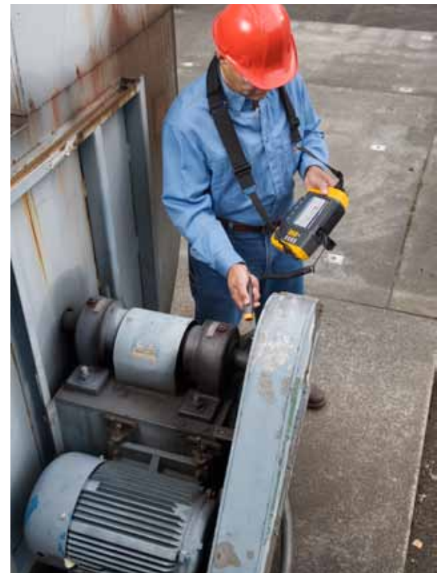
Si bien las vibraciones pueden ser normales durante el funcionamiento de una máquina, podrían representar tanto una señal como una fuente de problemas. El comprobador de vibraciones Fluke 810 portátil está diseñado y programado para diagnosticar los problemas más comunes de falta de equilibrio, holgura, desalineación y fallas en los rodamientos.
